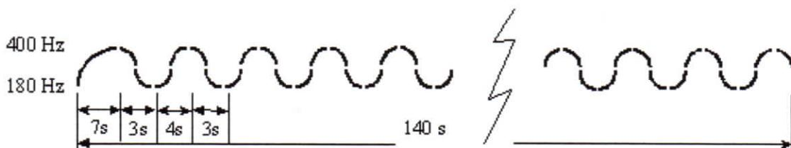
**ZKOUŠKA SIRÉN** – tento signál uslyšíte nejčastěji, a to zpravidla každou první středu v měsíci ve 12.00 hodin. Ověřuje se jím funkčnost systému a také slyšitelnost sirén. Pokud v tu dobu neslyšíte „svouj“ sirénu v místě Vašeho bydliště, nahlaste to na příslušný obecní úřad
